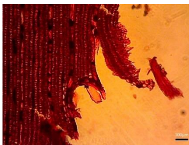
Gambar 27. Kerusakan mikroskopis akibat pemakuan menggunakan paku kayu
